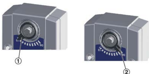
Рис. 149: Индикатор положения заслонки клапана
